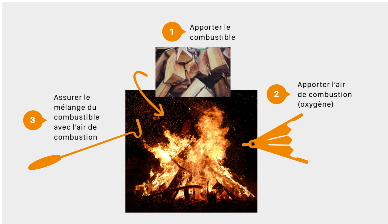
Fig. 9: Les trois actions principales de la combustion
