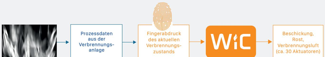
Abb. 13: Moderne Automatisierungssysteme liefern verschiedene Signale aus dem Verbrennungsprozess. Diese Signale sind der Fingerabdruck des aktuellen Verbrennungszustandes.
