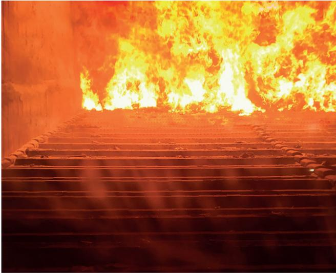
Abb. 7: Prinzip Rostfeuerungsanlage
